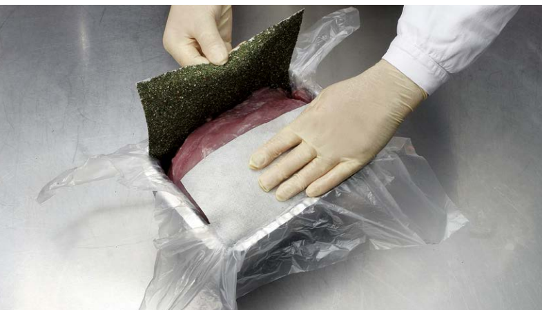
Fermer le film en le faisant se chevaucher, aspirer le vide et continuer à travailler comme d'habitude.
